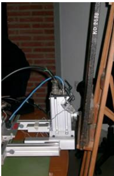
Φωτ.149: Η συσκευή και η εικόνα κατά την ώρα της σημειακής ακτινοβολήσης.
