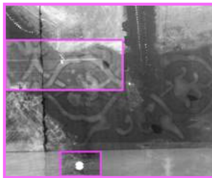
Φωτ.127: Λεπτομέρεια ακτινογραφίας. Διακρίνεται η ξύλινη καβίλια και το είδος των μεταλλικών βιδών με τις οποίες στερεώνεται το κάτω τρέσο. Δεν υπάρχει ίχνος διάβρωσης, διότι η προσθήκη του έγινε τα τελευταία χρόνια.
