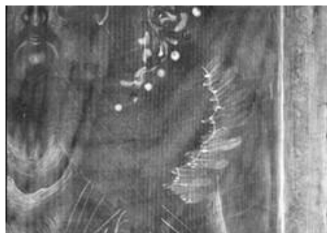
Φωτ.119: Λεπτομέρεια ακτινογραφίας. Καταγράφονται οι χαράξεις και τα κατακόρυφα νερά του ξύλου.
