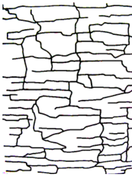
Σχήμα 2: Πλεγματοειδείς ρωγμές
