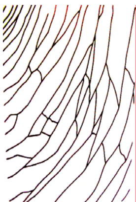
Σχήμα 9: Στεφανιαίες ρωγμές
