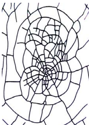
Σχήμα 8: Ακτινωτές ή αραχνοειδείς ρωγμές
