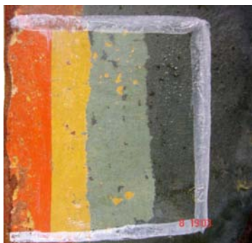
Εικ. 9: Δείγμα καθαρισμού στο οποίο διακρίνονται τα αλληπάλληλα στρώματα επιζωγράφισης στο φόντο.
