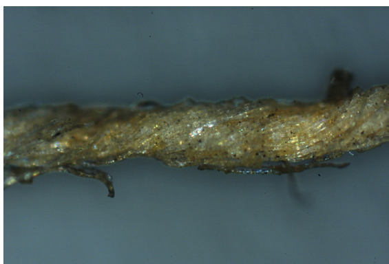
Εικόνα 18 : Υφάδι από τον υφασμάτινο φορέα του έργου 2. Παρατήρηση στο μεταλλογραφικό μικροσκόπιο.
